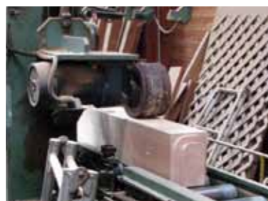
■プレカットと呼ばれる自動でほぞを刻む機械で製品化される。
