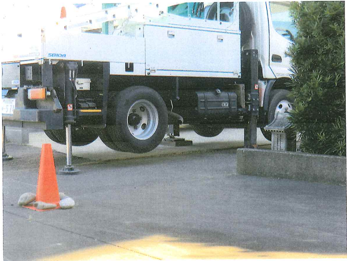
67リ711 輪止めの取付忘れ。
