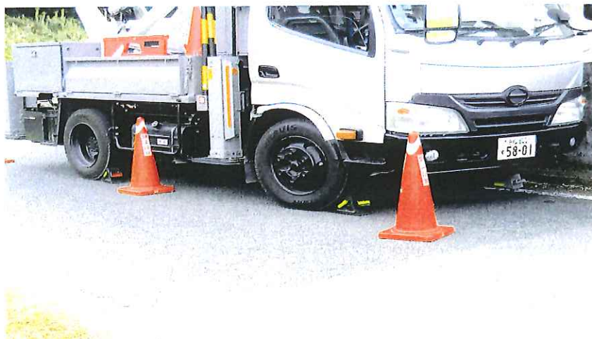
00ヤ601 坂道での駐車輪留を適切な使用で対策ができています。
