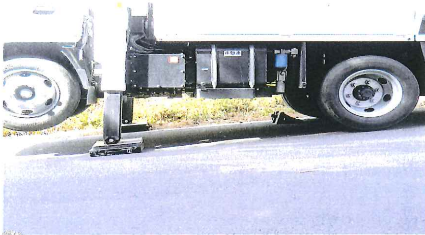
急な坂道 輪留を良サイドに取り付けて安全対策
