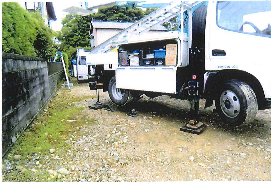
輪止め・ジャッキベースよし
