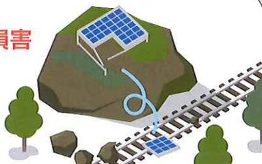
太陽光パネルや架台、風車ブレードなどの破損により、他者へ損傷を与えた事故。例えば、太陽光パネルの飛散や敷地内の土砂崩れによる土砂流出など、他者へ損傷を与えた場合が該当します。
