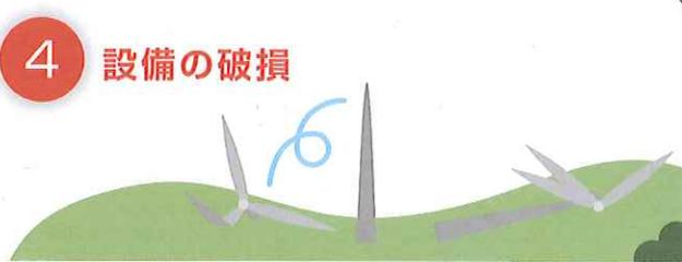
設備の破損により運転が停止する事故。例えば、風車タワーの倒壊や風車ブレードの折損、太陽光パネルの破損、パワーコンディショナーの焼損などが該当します。
