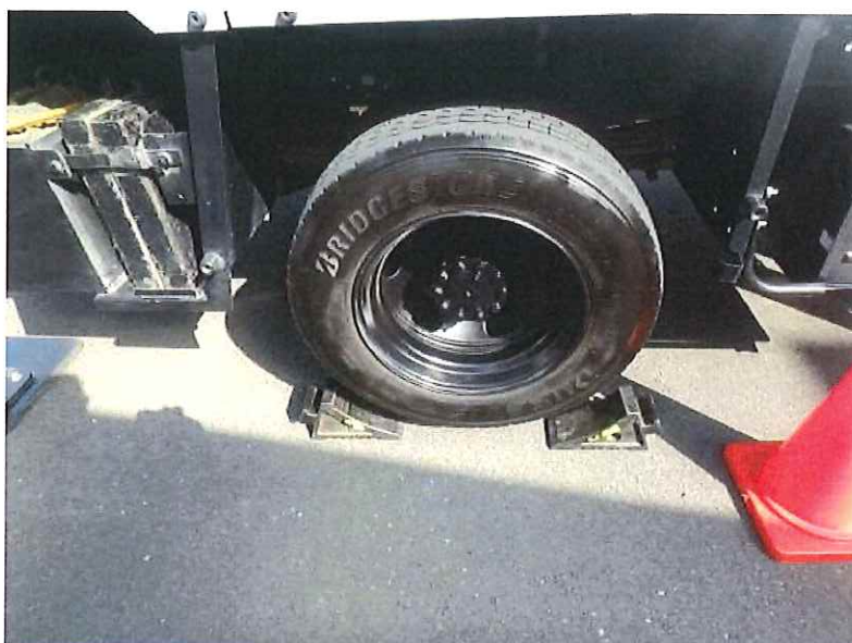
高所作業車輪止め設置状況
