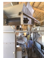
有機食品の製造ライン (茶葉→荒茶への製造ライン)
